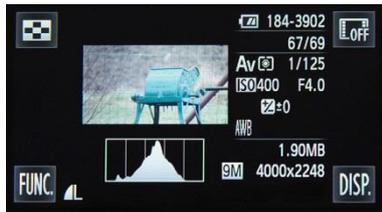
Jusqu'au grossissement de 36x, le système est diaphragmé par l'appareil photo à f/4. Nous voyons à gauche une photo prise avec priorité à l'ouverture (Av) à f/4 au grossissement de 25x. On obtient alors un temps de pose de 1/125 de seconde. A droite la même photo
