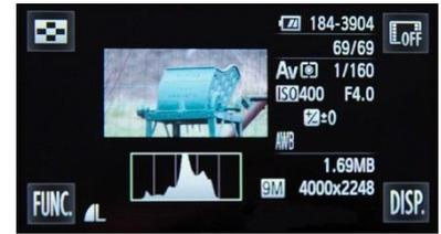
cette fois au grossissement de 36x, résulte en un temps de pose de 1/160 de seconde peu différent de 1/125 de l'autre image. Ceci tend à prouver que le diaphragme du système ne varie pas de l'une à l'autre.
